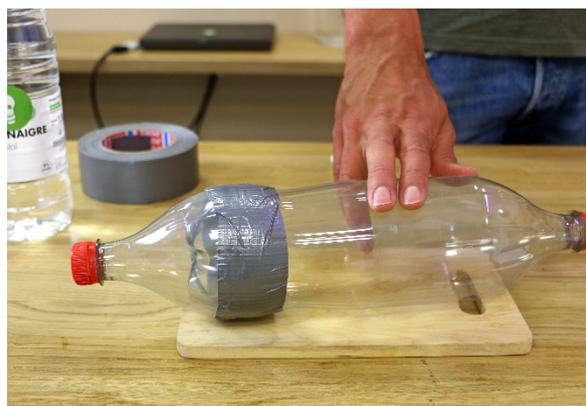
b. Schiebt diesen abgeschnittenen „Flaschenkopf“ über den Boden der anderen PET-Flasche und klebt ihn mit Panzertape fest.
