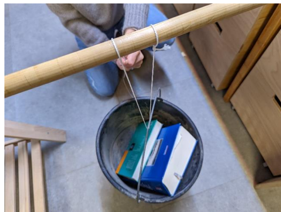
6) Fahre mit dem Faden durch den Henkel des Eimers, dann wieder hoch und über den Besenstiel. Ziehe am freien Fadenende, bis du den Eimer mitsamt Gewicht hochhebst.
